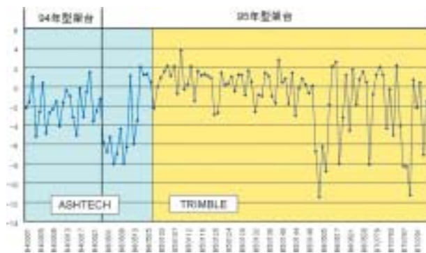
図-1 アンテナ交換前後におけるGEONET解析値の差(高さ成分: cm)。左が94年型架台、右が95年型架台。アンテナは、青の領域がASHTECH、黄色の領域がTRIMBLEである。
