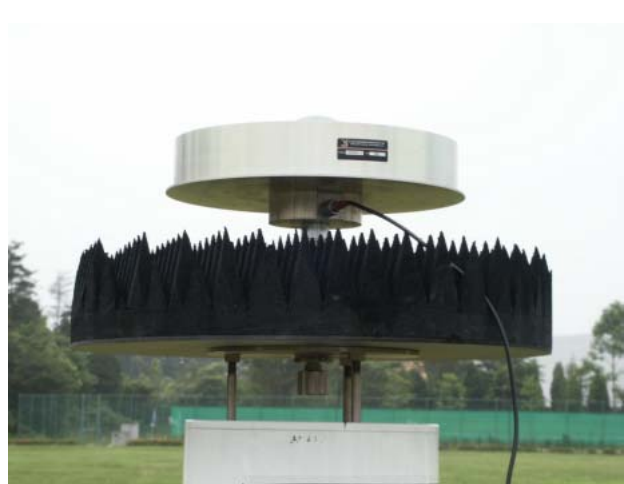
写真-2 電波吸収材の設置
