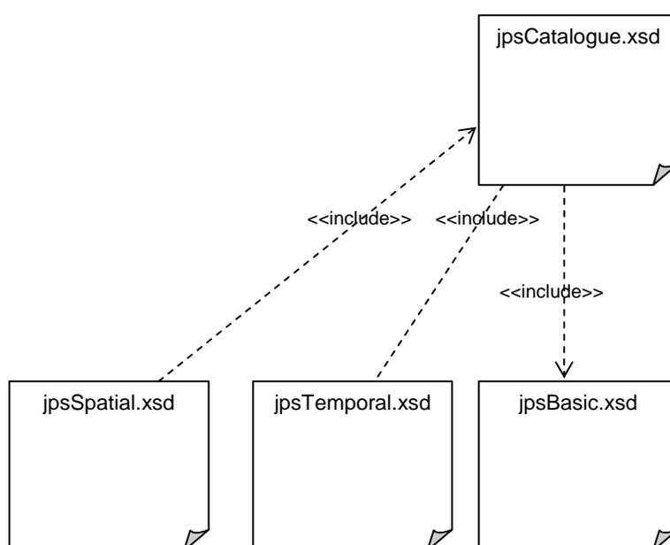
図附 8-21 標準 XML Schema の構成
