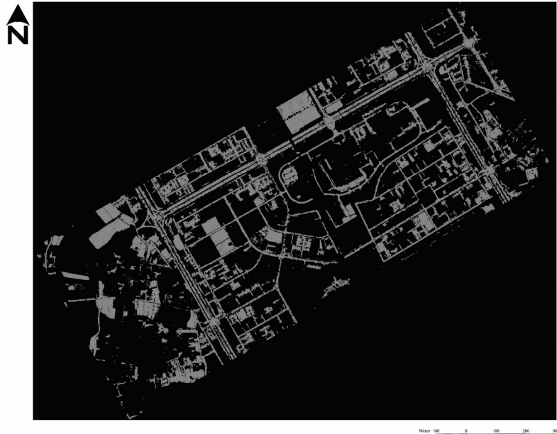
図-1 反射強度と高さデータを利用した道路領域の抽出結果
