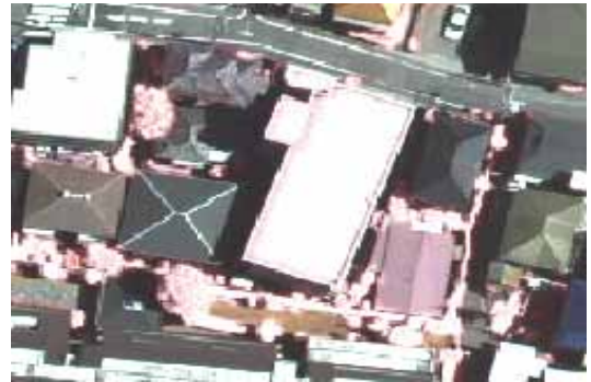
図-5 植生と似た近赤外線反射特性を示す人工構造物の例
