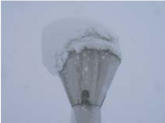
写真 - 2 新庄の着雪状況
