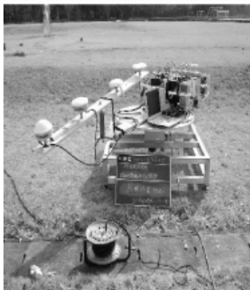
図1 回転移動測位実験（左）と実験結果の例（右）
