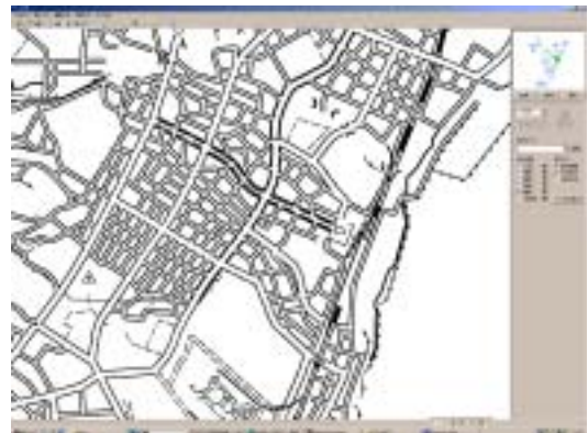
図2 1/2.5万NTIS全データを1/5万図式描画した画像(建物を除いた墨版)約1/38,000に拡大
