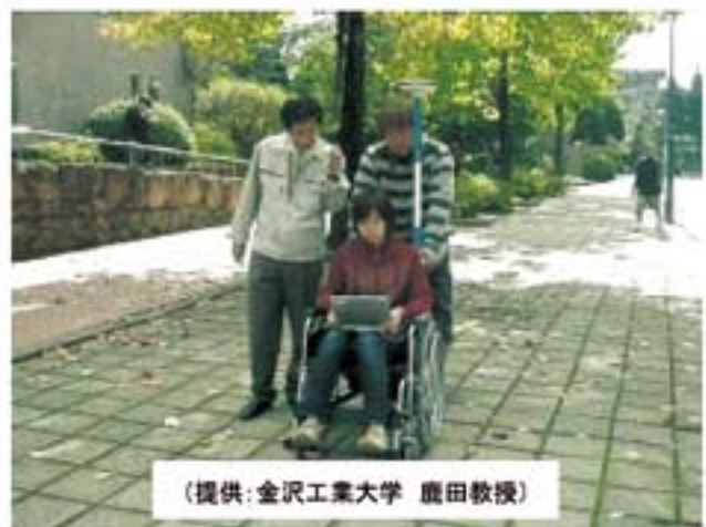
図-15 車椅子に取り付けたネットワーク型RTK装置
