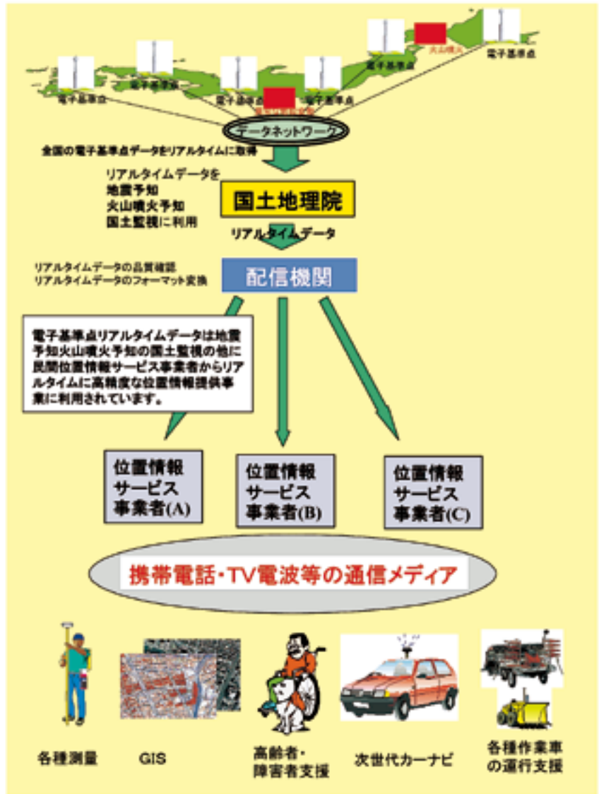
図-13 電子基準点リアルタイムデータの流れ
