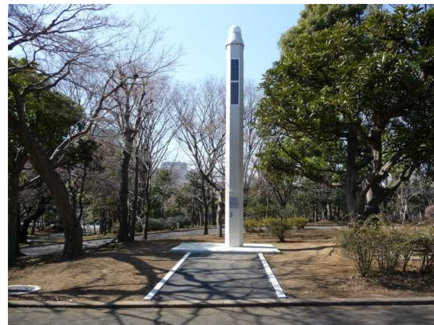
竣工した電子基準点「東京千代田」
