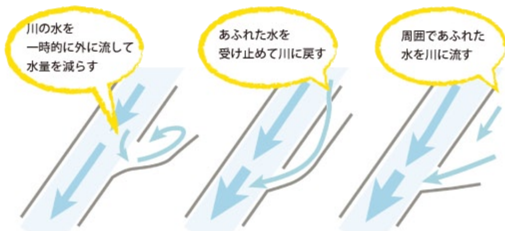
図2-5 霞堤の仕組み
