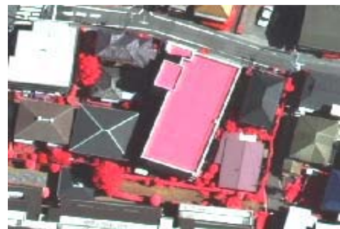
図-20 植生と似た近赤外線の反射特性を示す人工構造物の例
