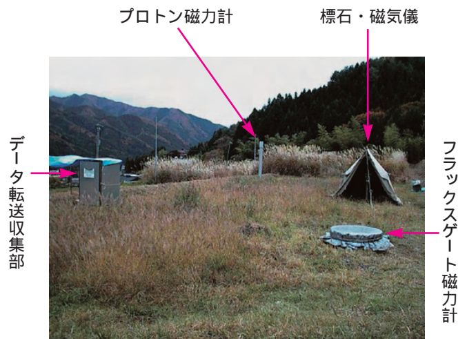
写真 - 2 地球電磁気連続観測装置の全景（岐阜県益田郡萩原町）
