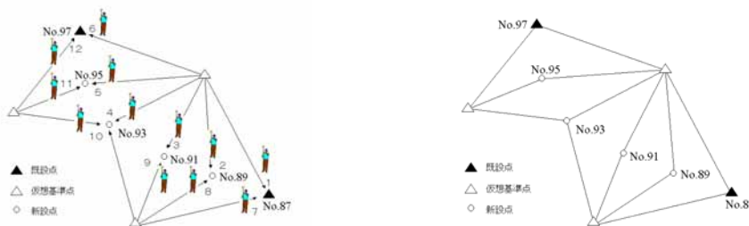
直接法(GPS測量機1台)による観測例及び平均図
